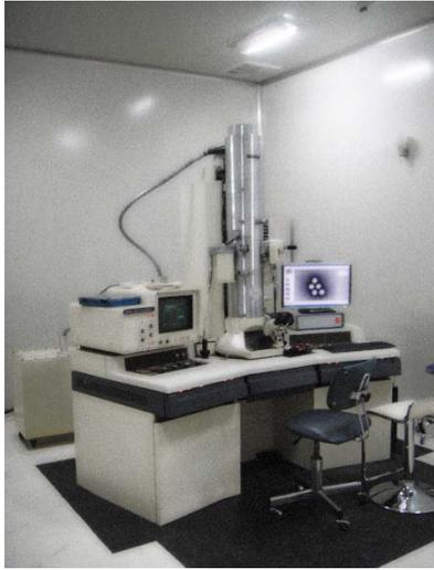
设备名称：100KV透射电子显微镜
