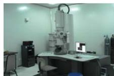
200KV冷冻透射电镜
